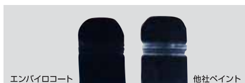
スクラブテスト 専用の機器を使いワイヤーブラシ で200回往復する摩耗テスト
